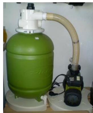
237. ábra Vízszintes tengelyű forgatószivattyú, durvaszűrővel
