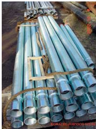
147. ábra Kútfúráshoz használt menetes csövek, és a kút szerkezete
