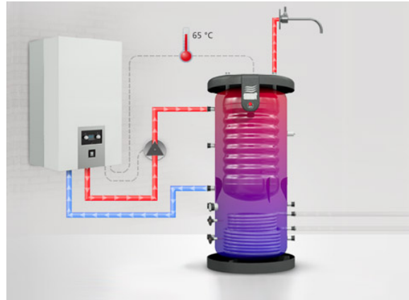
190. ábra Tank-in-Tank, azaz tartály a tartályban.
