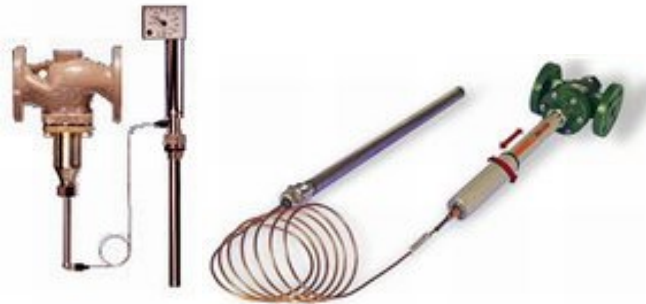
206. ábra Segédenergia nélküli hőfokszabályozó karimás szelepek termosztáttal és kapillárisal
