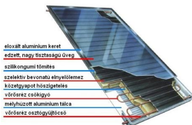
262. ábra Síkkollektor képe és szerkezete
