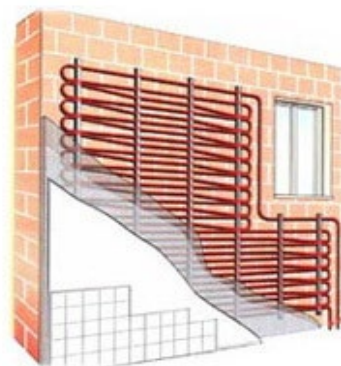
81.ábra Falfűtés függőleges és vízszintes csővezetéssel
