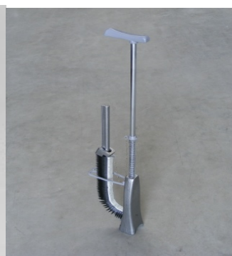
75. ábra Leszúró klipsz és a klipszhez leszúró szerszám:
