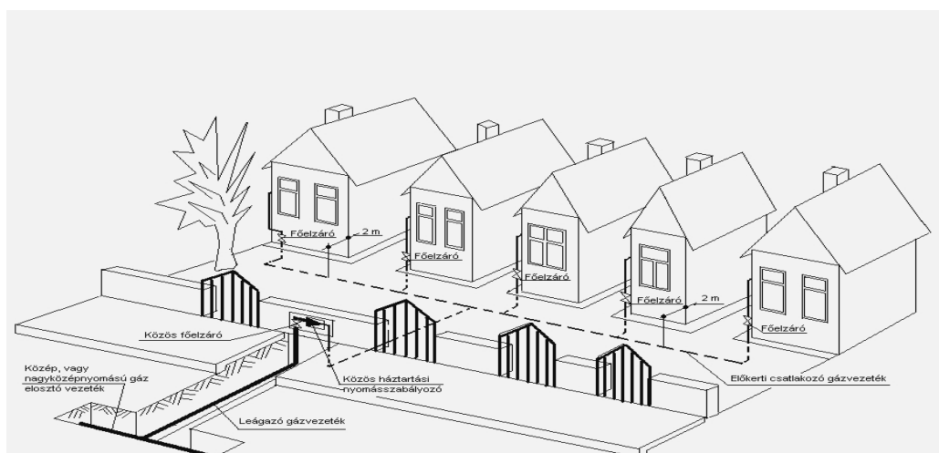
76. ábra Közös nyomáscsökkentő több épületnek
