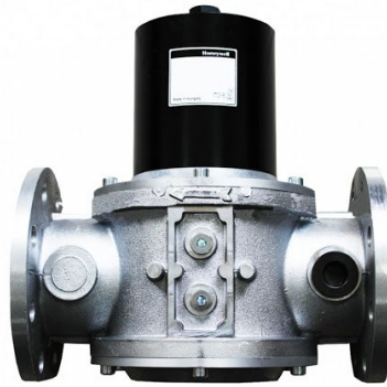
139. ábra Honeywell VE4080B3004 gázmágnesszelep DN80 NC, gyors nyitású, p_{max}=200\text{mbar} 230 Vac IP54 karimás
