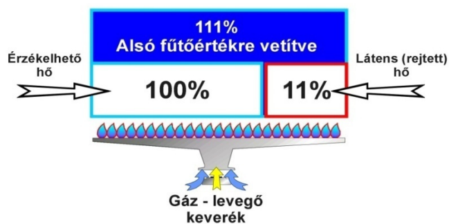
173. ábra A kondenzátum rejtett hője
