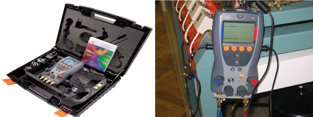
159. ábra Testo 560-1 műszerbőrönd és a hűtőrendszerre kapcsolt műszer
