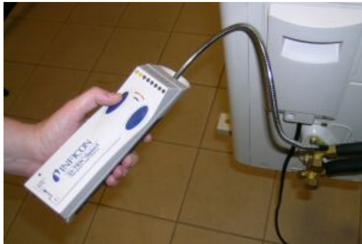
154. ábra Infravörös technikával működő szivárgáskereső
