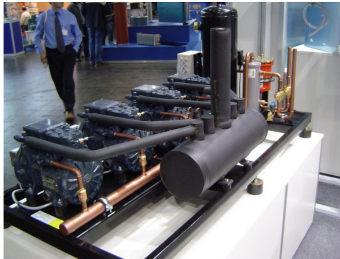
57. ábra Kompresszorcsoport félhermetikus kompresszorokkal
