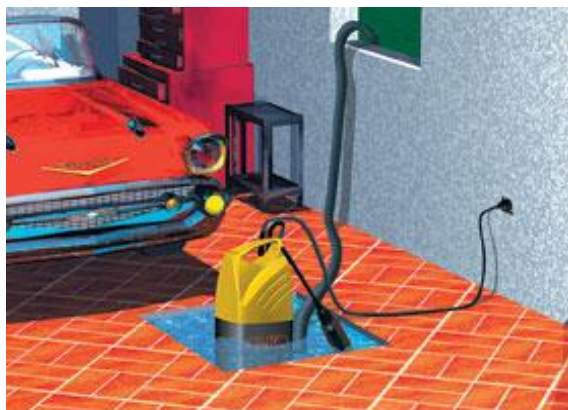
62. ábra Búvárszivattyú elhelyezése pincegarázsban
