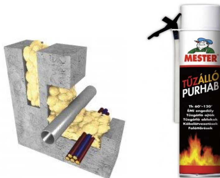
25. ábra Átvezetés tűzgátló hab alkalmazásával
